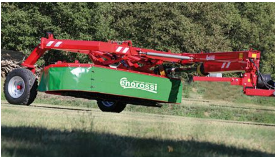
Битерный плющильный аппарат FLAX со стальными ножами.
