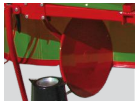
Стандартный диск и барабан для формирования валка.
