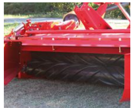
Обрезиненный вальцовый плющильный аппарат ROLL.
