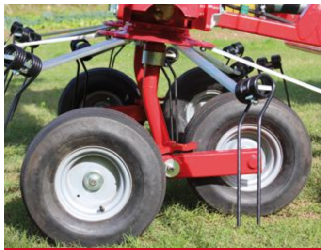
Сдвоенные оси на модели G6V PTH
