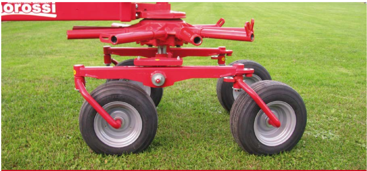
Doppia ruota per il modello RR 350 TANDEM. / Tandem axles with pivoting tires on RR 350 TANDEM. / Doble ruedas tándem en el modelo RR 350 TANDEM. / Double roue pour modèle RR 350 TANDEM.
