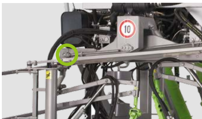
Регулировочные винты на задней оси для регулировки ширины колеи
