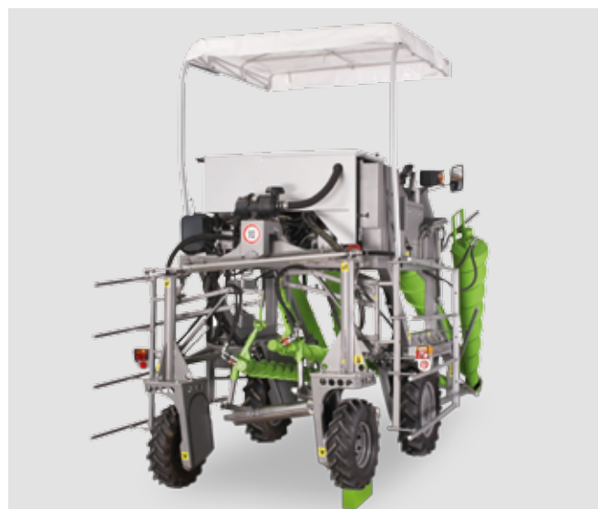
Маятник оси на подвеске задних колес обеспечивает точное повторение рельефа местности
