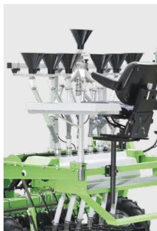
Шесть отдельных воронок в комбинации с ротационным дозатором
