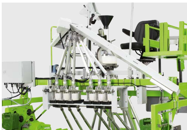
Магазинная система в комбинации с коническим дозатором для сплошного посева
