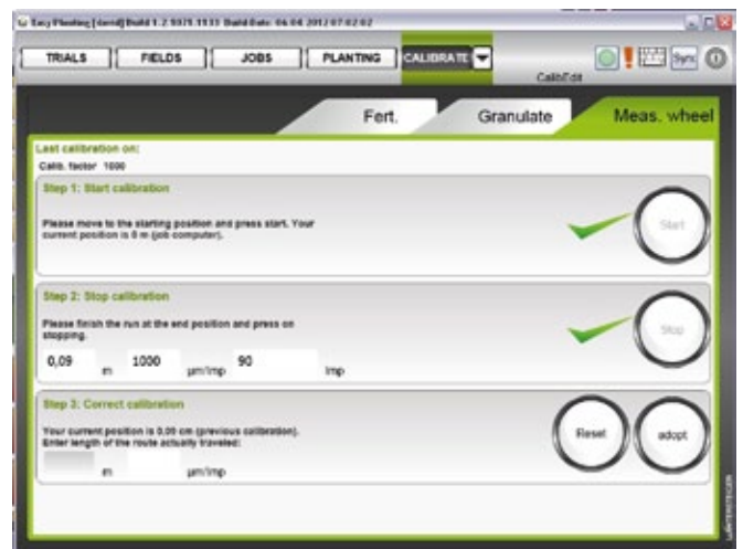
Простая калибровка колеса для измерения пути, удобрения или микрогранулята
