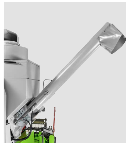
Разгрузочный шнек зернового бункера с гидравлическим приводом
